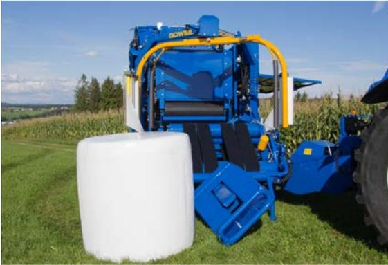
Ballenablagerampe mit Ballenaufsteller
