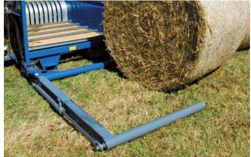
Abbildung 2 - Hydraulischer Ladearm
