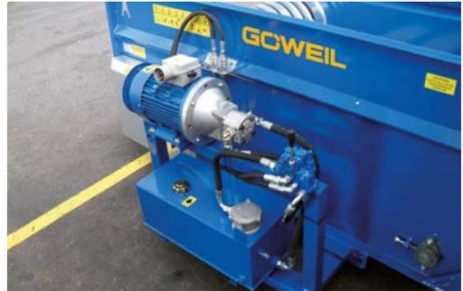
Abbildung 4 - Elektroantrieb
