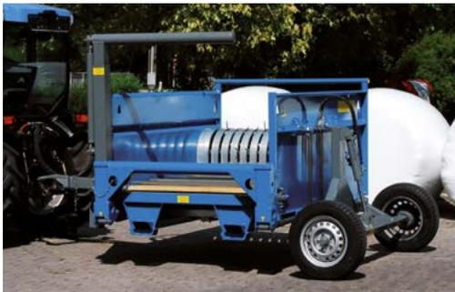
Abbildung 5 - Fahrwerk mit Zugdeichsel
