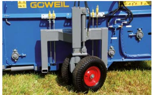
Abbildung 6 - Fahrwerk mit Schwenkräder
