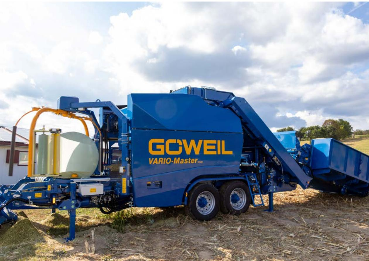
Press-Wickelkombination mit variabler Presskammer
