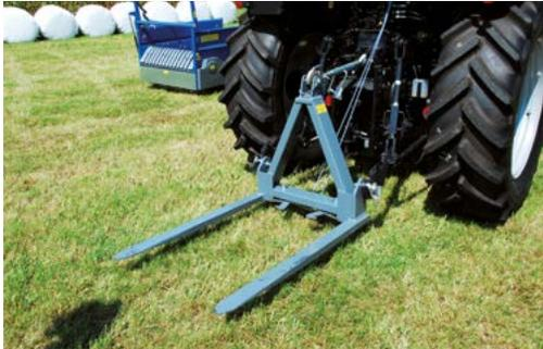
Abbildung 1 - Dreipunktanbau Kat. II mit Staplergabel
