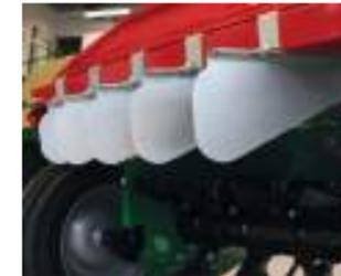
Das Ablageblech kann in der Höhe verstellt werden. Die 10 Leitbleche können individuell und stufenlos den Verhältnissen angepasst werden.
