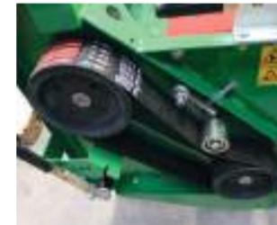
Der grosszügig ausgelegte Rotorantrieb ist mit Spezial-Keilriemen bestückt. Diese können von aussen mittels Schraube nachgespannt werden. Das Riemenverdeck ist mit einer Wartungsöffnung versehen.
