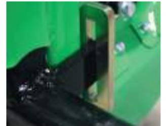
Die Stützräder sind mittels Steckbolzen einfach in der Höhe verstellbar.
