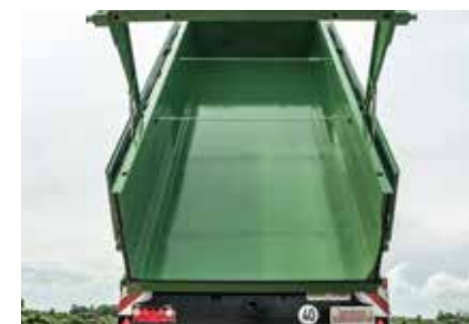
konische Mulde für leichteres Abrutschen des Lade- gutes
