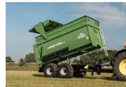
TA 20053/2 PT+ mit konischer Mulde, durchgehend aus 4 mm starkem Stahlblech
