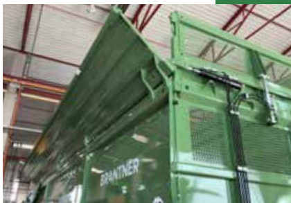
hydr. abklappbare Aufsatzwand wahlweise seitlich links oder rechts
