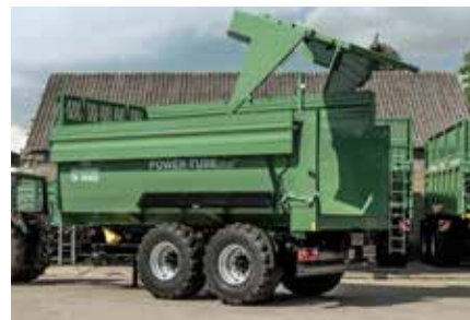
abklappbare Aufsatzwände hydraulische Rückwand kann bei ab- geklappten Aufsatzwänden geöffnet werden
