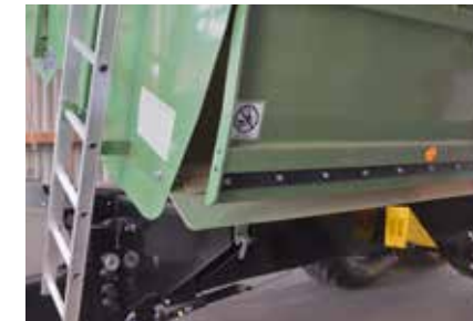
Rutsche für schonendes Abladen über seitlich klappbare Rutsche
