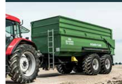
TA 22053/2 XPT+ durchgehend aus 6 mm Stahlblech, Höhe 1000 mm
