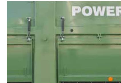
geteilte Wände für mehr Stabilität der Mulde
