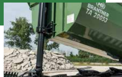
Frontzylinder hartverchromt für besonders hohe Hubkraft und Kippwinkel über 50 Grad
