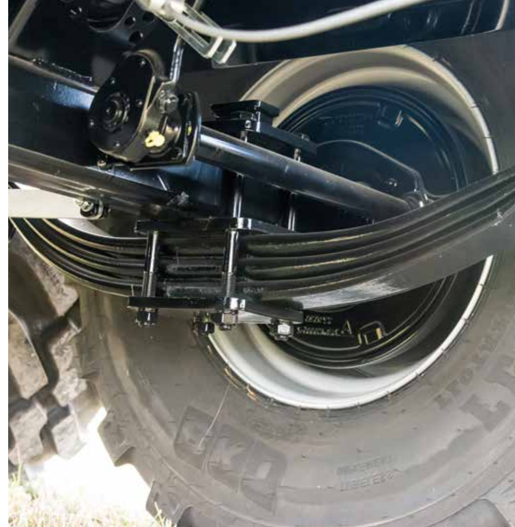
32 to Federaggregat mit verstärkter Ausgleichswippe
