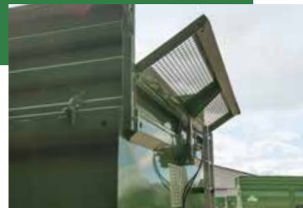
Stirnwand hydraulisch abklappbar
