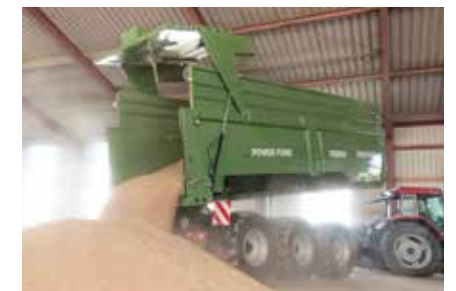
TR 34080/2 PT+ 34 to Gesamtgewicht, auf Wunsch mit hydraulisch-mechanischer oder elektrischer Zwangslenkung
