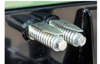
Kettenspanner automatische Kettenspanner mit Anzeige an vorderer Bordwand
