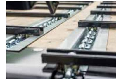
2 Kettenstränge (Rundstahlkette 10x31 mm), Bruchlast 12,5t, galvanisch verzinkt, paarweise kalibriert
