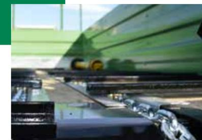
Ketten laufen am Plateau versenkt in durchgehenden verzinkten Führungsleisten
