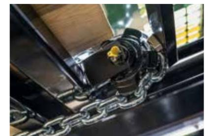
Umlenk-Kettenrad hergestellt aus verschleißfestem Sphäroguss, optional auch über Schmierleiste schmierbar
