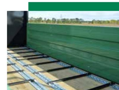
Kratzbodenleisten aus hochfestem U-Stahl (40x20 mm), mit Kette verschraubt
