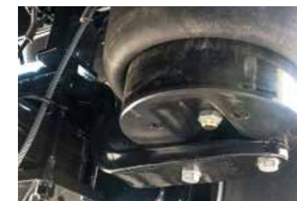
Luftfederung mit Zweiblattlenker für optimale Standsicherheit und Geländegängigkeit
