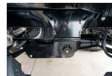
versetztes Tandemaggregat Federung bei Lenkachse angepasst, bessere Standsicherheit und Reduzierung der Wankneigung
