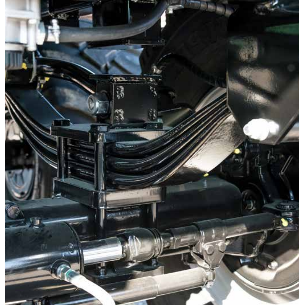
32 to Federaggregat mit verstärkter Ausgleichswippe
