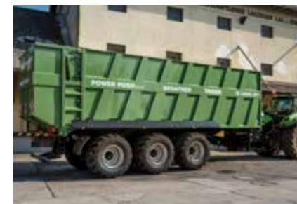
TR 34090 PP+ Tridem Fahrwerk, 34 to GesGew., 43 oder 49 m³ Ladevolumen
