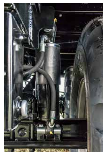
Hydraulikfederung höchstmögliche Kurven- und Hangstabilität
