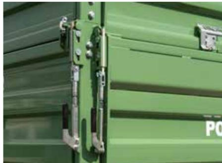
HB - LKW Verschlüsse, mit Bordwandversteifung
