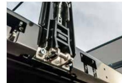
**werkzeuglos abnehmbarer Mittelsteher**
