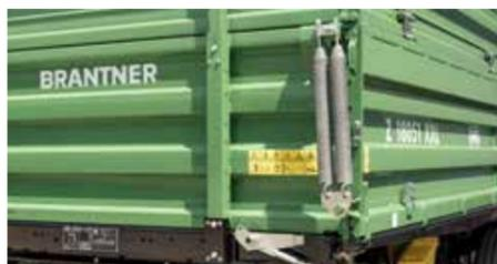
Doppelte Bordwandhebefeder, drehbar gelagert
