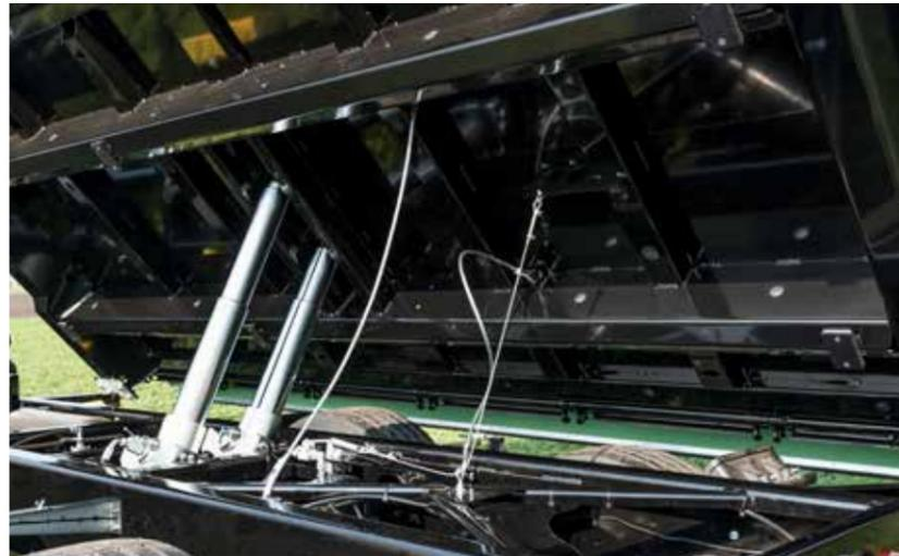
Trapezkipprahmen nach LKW Bauart inkl. Versteifungsrippen
