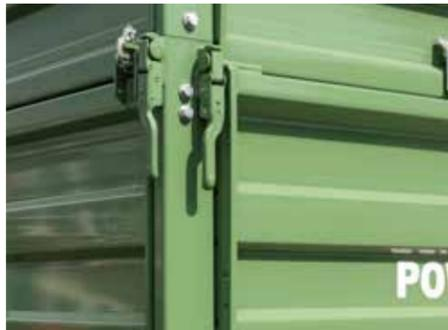
Hestalverschlüsse, ohne Bordwandversteifung
