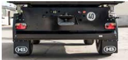
Multi-Point Beleuchtung mit Kotspritzgummi für Kotflügel
