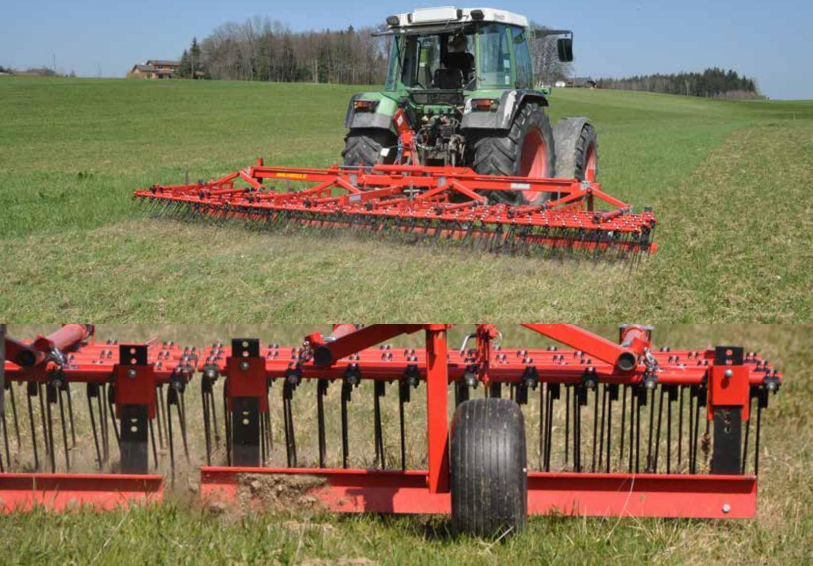
Vorne am Striegelfeld kann ein mit einer Blattfeder gegen Überlastung gesichertes Frontstreifblech befestigt werden. Dieses **Frontstreifblech** ist im Lochraster höhenverstellbar und garantiert eine optimale **Verteilung und Einebnung von Maulwurfshügeln**. Es ist auch zum Einreiben und Verteilen von Kuhfladen, Gülle und Mist besonders gut geeignet. Eine nachträgliche Montage ist einfach durchführbar (nur bis 6 m Arbeitsbreite).
