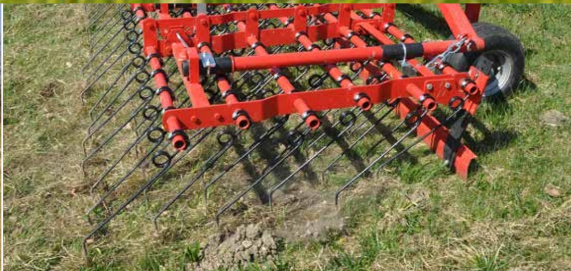
Am **6-reihigen Striegelfeld** sind auf 1,5 m Arbeitsbreite 60 Zinken montiert, dies ergibt einen **Strichabstand von 2,5 cm**. Nur dieser Strichabstand garantiert Ihnen das Ausarbeiten von Verfilzungen und somit den gewünschten Arbeitseffekt.
