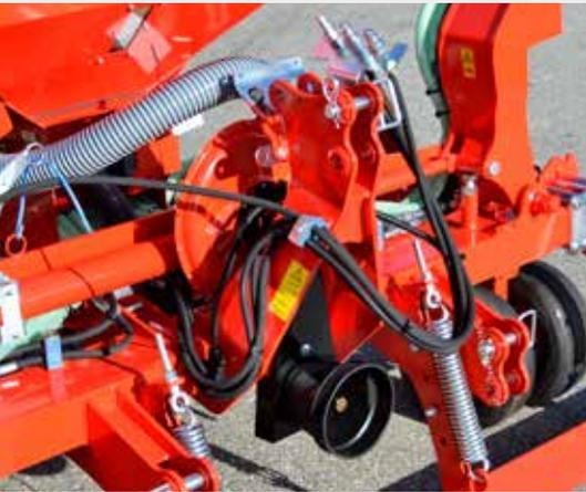
Mit dem **mechanischen Gebläse** können Sie aufgrund einer höheren Luftmenge bis 6 m Arbeitsbreite schwereres Saatgut ausbringen und höhere Arbeitsgeschwindigkeiten fahren. Empfohlen für Maschinengemeinschaften und Lohnunternehmer.
