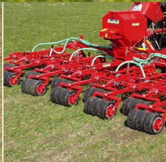
Die **hydraulische Zinkenverstellung** erleichtert Ihnen die Anwendung des GRASS-MANAGER, PNEUMATICSTAR-MD und PNEUMATICSTAR-STI bei **wechselnden Bodenverhältnissen**. Sie ist auch von Vorteil beim Klappen zur Transportstellung, da sie die Zinken in eine flache Stellung bringen. Eine nachträgliche Montage ist möglich.
