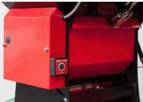
Der **Oberlenkersensor** schaltet die Säwelle bei angehobenem Gerät automatisch ab (serienmäßig).
