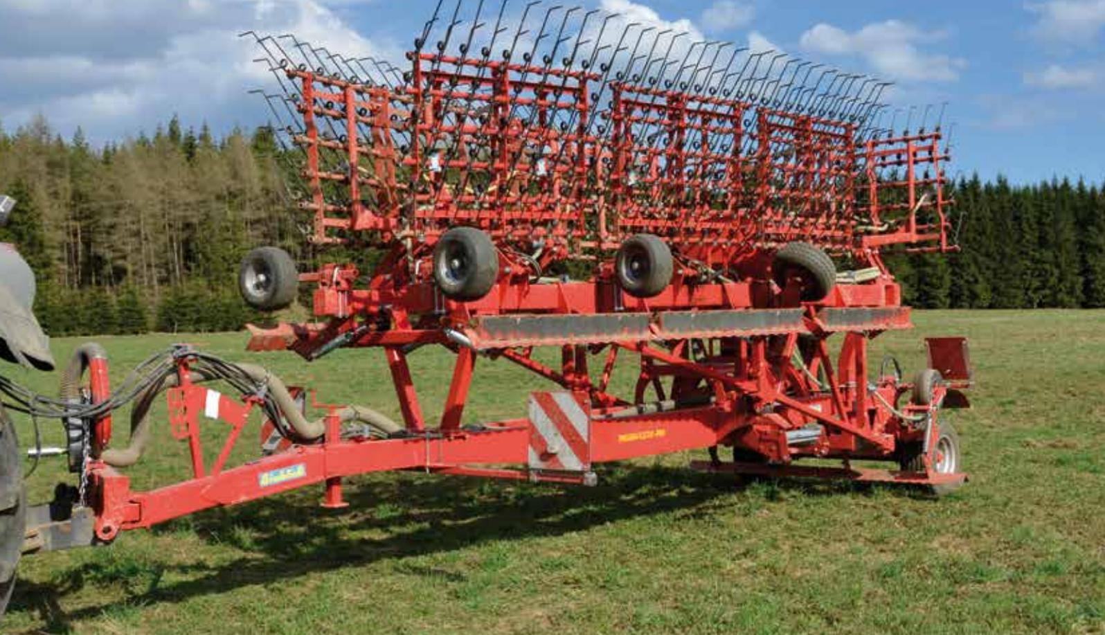
Durch den ausgeklügelten **Klappmechanismus** und das Zurückstellen der Zinken in die flachste Position wird eine Transportbreite von nur 3 m erreicht.
