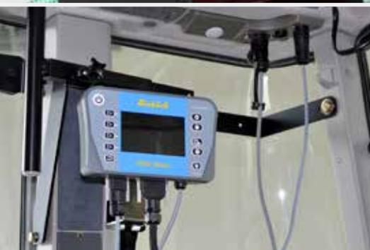
Die **Sensoren der Luftstromüberwachung** erkennen, ob ein oder mehrere Säschläuche verstopft sind und zeigen eine Fehlermeldung in der Steuerung an (optional).
