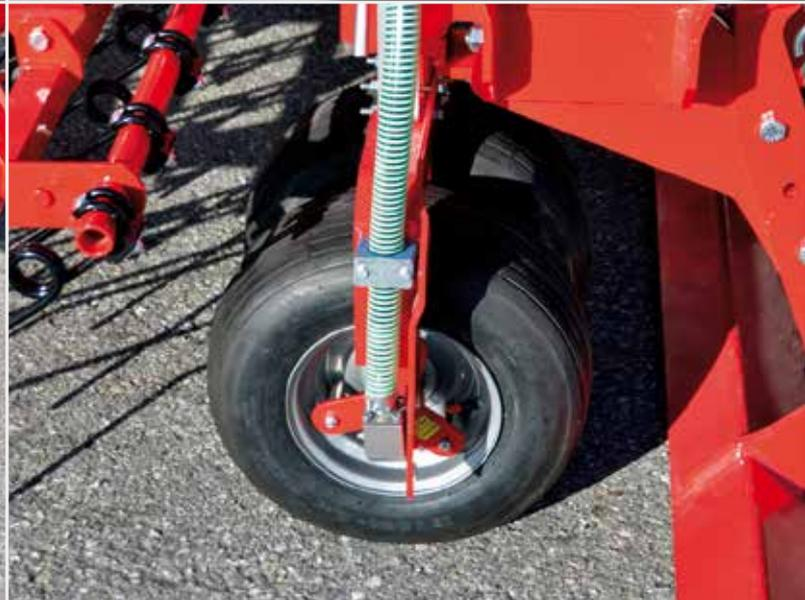
■ **Bodenantrieb** über Stützrad (PNEUMATICSTAR-MD)
