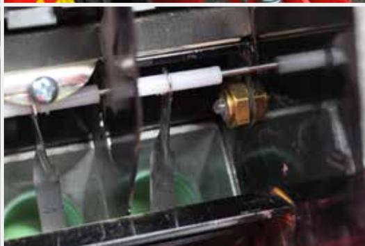
Der **Füllstandsensor** meldet, wenn sich das Saatgut dem Ende zuneigt. Der Sensor arbeitet induktiv und ist dadurch erschütterungsunabhängig (optional).
