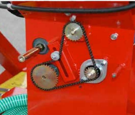
Eine **großdimensionierte Kette** mit Kettenspanner bildet die Kraftübertragung vom stufenlosen Ölbadgetriebe bzw. vom elektrischen Säwellenantrieb zur Säwelle und Rührwelle.
