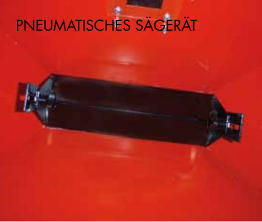
Für schweres Saatgut empfehlen wir das **Rückhalteblech**, das über der Rührwelle und der Säwelle montiert wird.
