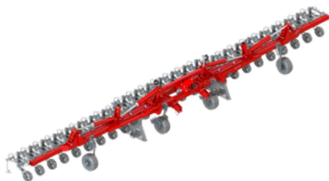
7. Heckrahmen mit Längsfahreinrichtung (Transportbreite unter 3m)
