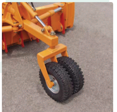
Hydraulische Stützradverstellung: Falls die Schürftiefe nicht mit der Heckhydraulik geregelt wird.
