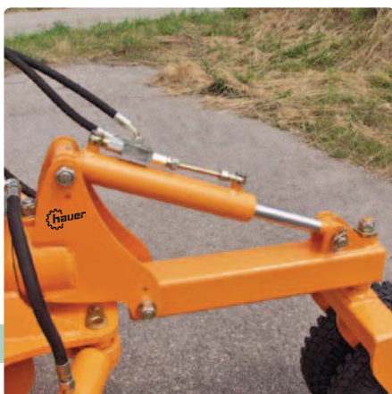
Hydraulische Stützradverstellung: Falls die Schürftiefe nicht mit der Heckhydraulik geregelt wird.
