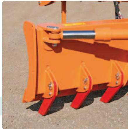
Aufreißer: Aus gehärtetem, verschleißfestem Spezialstahl (ca. 400HB). Die Aufreißer sind durch eine Überlastsicherung geschützt. Die Halterungen sind serienmäßig auf dem Planiergerät vorhanden.
