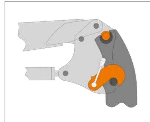
Das Konsolensystem **TBS-HV** ist durch die Lage der Befestigungspunkte und den 60 mm starken Lagerbolzen für die Übertragung besonders großer Kräfte optimal dimensioniert.
