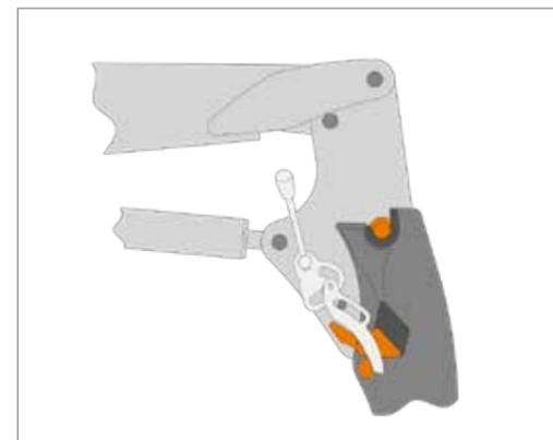
Das „TOP-BLOCK-KII“ wird als optionale Ausrüstung zum TOP-BLOCK-System angeboten. Dieses Kuppelsystem verriegelt beim Ankuppeln automatisch.
