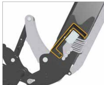
Mit dem 5-eckigen Schwingenprofil und dem doppelwandigen Querträger wurde eine verwindungssteife Konstruktion für härteste Einsatzbedingungen entwickelt. Für die gute Übersicht ist der Querträger in Blickrichtung des Fahrers gedreht.
