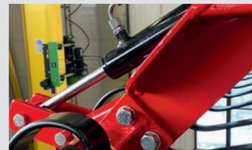
Vorwerkzeug hydraulisch wegklappbar
