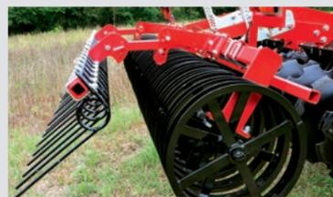
Striegel mit Höhenverstellung und Winkelverstellung
