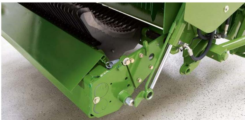
Beim Einschwenken des Messerbalkens erfolgt die Verriegelung auf der gegenüberliegenden Seite automatisch.
