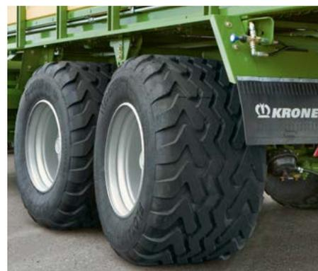
**Ungefederte, un gelenkte Portal-Tandemachse mit zul. Achslast von 10.000 kg:**
