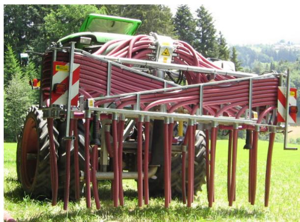
Das Ausbringen der Gülle mittels Verschlauchung besteht durch ausgeprägte Bodenschonung. Im Gegensatz zum Güllefass muss viel weniger auf den Bodenzustand geachtet werden, was die Flexibilität erhöht. Allerdings darf das nicht dazu verleiten, die Gülle auf durchnässten und nicht aufnahmefähigen Boden auszubringen. Die enorme technische Entwicklung in den letzten Jahren, macht die Verschlauchung zu einem äusserst schlagkräftigen Ausbringssystem.
