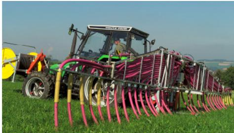
Kompakt, bodennah, effizient und umweltfreundlich. Das verlustarme und windunempfindliche Ausbringen, ermöglicht den Einsatz von Gülle zum optimalen Zeitpunkt. Ein spezieller Verteilkopf macht den Hadorn Spider Compact extrem hangtauglich und ermöglicht dabei eine gleichmässige Verteilung der Gülle. Stickstoff, der dank Schlepplschlauchsystem nicht verloren geht, bewirkt einen Mehrertrag.
