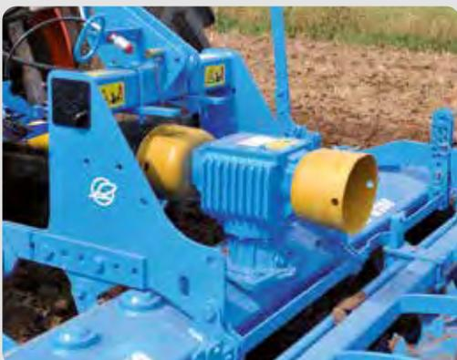
**Einfache Kraftübertragung durch das Wechselradgetriebe**
