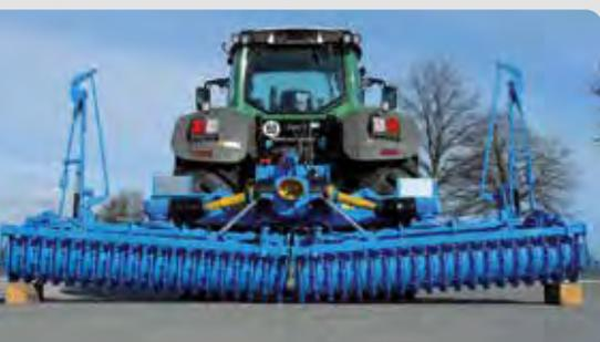
**Optimale Boden Anpassung durch zentrale Pendelachse**
