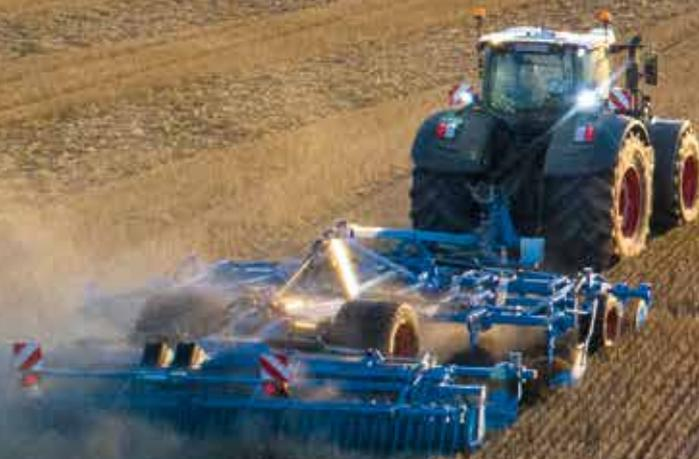
Bereits auf den ersten Blick zeigt sich der neue dreibalkige Grubber **Karat 10** aufgeräumter durch überarbeitete Zinkenanzahl. Die Zinken sind nunmehr symmetrisch zur Zugachse angeordnet, wodurch die neue Maschine extrem leichtzügig ist und gleichzeitig eine intensive Durchmischung garantiert. Das ist beim Einsatz des Grubbers mit Spurführungssystemen besonders wichtig.
