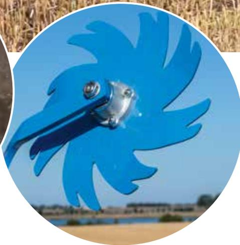
Optionale Randeinebnungswerkzeuge, wie Seitenschild, Randnivelierscheibe oder Randnivelierzinken sorgen für eine optimale Einebnung an den Außenseiten des Grubbers. Exaktes Anschlussfahren wird so ermöglicht. Die Randscheiben lassen sich mechanisch oder hydraulisch nach oben klappen. So kann auch mit eingeklappten Randscheiben, z. B. an Zäunen entlang, problemlos gearbeitet werden.
