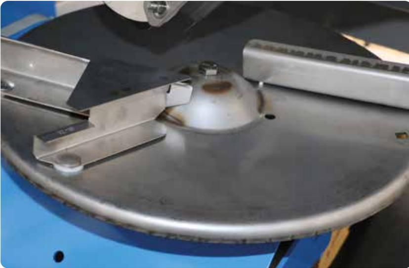
Die **ECOBORD**-Wurfschaufeln werden beim **Spica 8** eingesetzt, um den Dünger nicht über die Feldgrenze hinaus zu streuen. Sie lassen sich schnell und einfach – ganz ohne Werkzeug – an den Streuscheiben montieren.
