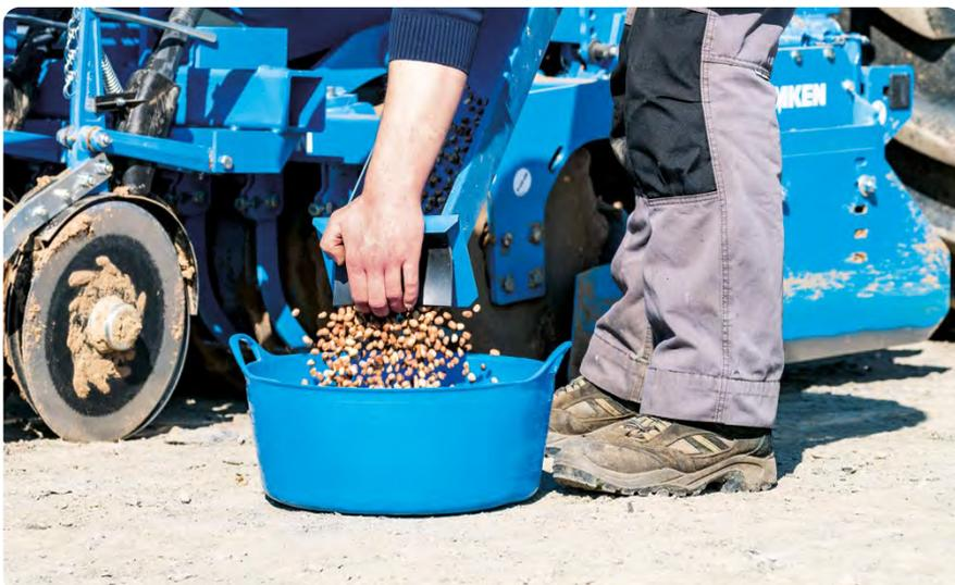
Die **Abdrehprobe** lässt sich schnell und einfach durchführen, da das Saatgut in zwei Abdrehmulden aufgefangen wird. Diese werden über praktische Auszüge seitlich in die Maschine hinein- und herausgezogen. Über seitliche Entleerungskappen fließt das Saatgut direkt in den Wiegebehälter.
