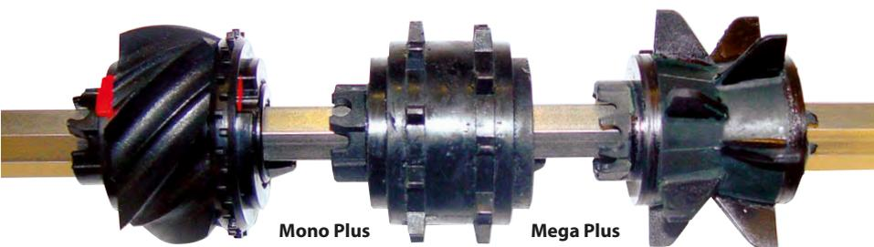
Die **Saphir** ist mit einer Sechskant-Säwelle mit Schnellwechselsystem ausgerüstet. Der Austausch der Säräder ist denkbar einfach. Zur Verfügung stehen zwei einteilige Säräder:
