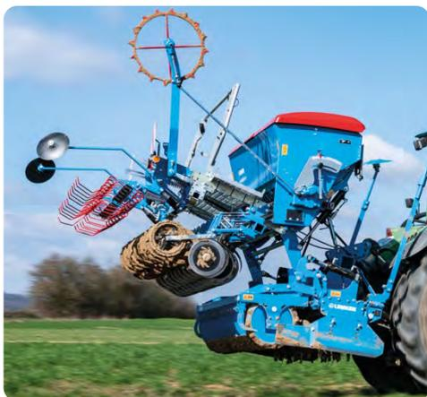
Dank des optionalen **Aufsattelkonzeptes** lässt sich die **Saphir** mittels Hydraulikzylinder gleichzeitig ausheben und nach vorne schwenken. Das senkt die Vorderachsbelastung. Mit den Hydraulikzylindern lässt sich außerdem mit Hilfe von Hydro-Clips die Position des Grundrahmens zur Scharschiene individuell einstellen.
