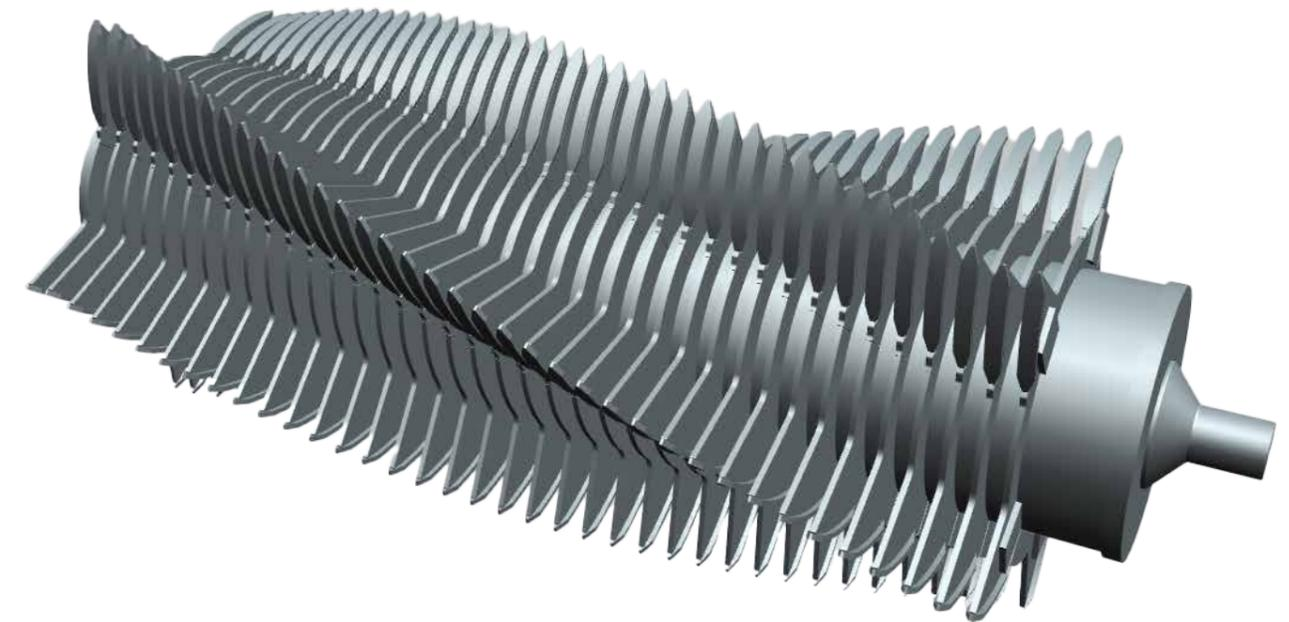
Der Förderrotor des Zelon hat dank seiner großen Förderbreite von 1500 mm und einem Durchmesser von 725 mm eine hohe Durchsatzleistung. Die 8 mm breiten Förderzinken sind auf 5 Zinkenreihen spiralförmig angeordnet und durchgehend mit dem Rotorrohr verschweißt. Das macht den Rotor äußerst robust, langlebig und leichtzügig.
