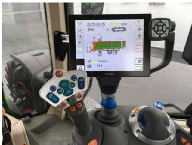
Durch die Kompatibilität der Strautmann ISOBUS Steuerung können unterschiedlichste Terminals für die Strautmann Ladewagen genutzt werden. So können je nach Schlepper-Typ auch sämtliche Maschinenfunktionen über den Schlepper-Joystick bedient werden.
