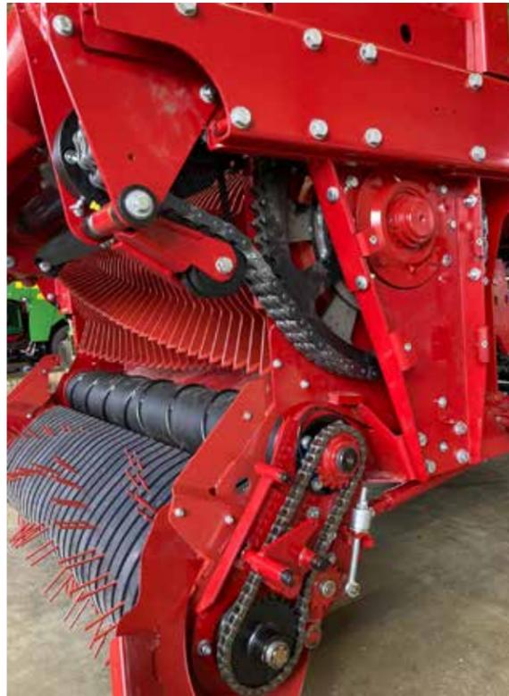
Das Ladeaggregat des Zelon wird über eine 1 ¼ Zoll starke Duplexkette auf der linken Rotorseite angetrieben. Der serienmäßig verbaute automatische Kettenspanner sowie eine automatische Ketten-schmierung reduzieren den Wartungsaufwand auf ein Minimum. Das steigert die Effizienz und erhöht die Lebensdauer der einzelnen Bauteile.
