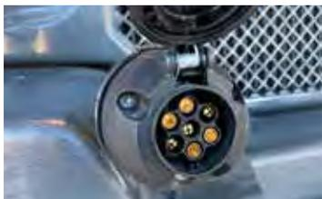
Die 7-polige Anhängersteckdose wird an der hinteren Stoßstange des Laders montiert. Diese ist nur in Verbindung mit dem Kommunalpaket (Option) verfügbar. Die Standards für Anhängersteckdosen variieren in verschiedenen Ländern, wenden Sie sich bitte an Ihren örtlichen Avant-Händler.
