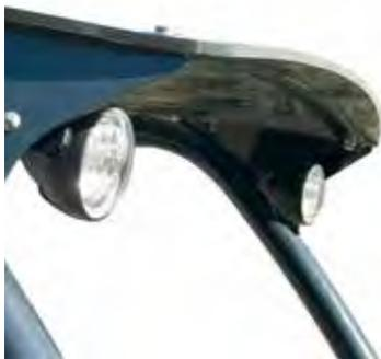
Die zusätzlichen LED-Arbeitscheinwerfer ermöglichen den sicheren und effizienten Einsatz des Laders auch bei Dunkelheit. Sie haben die Wahl zwischen LED-Scheinwerfern mit 2810 Lumen oder 2500 Lumen. Die 3 Leuchten werden im Front- (2) und Heckbereich (1) montiert.
