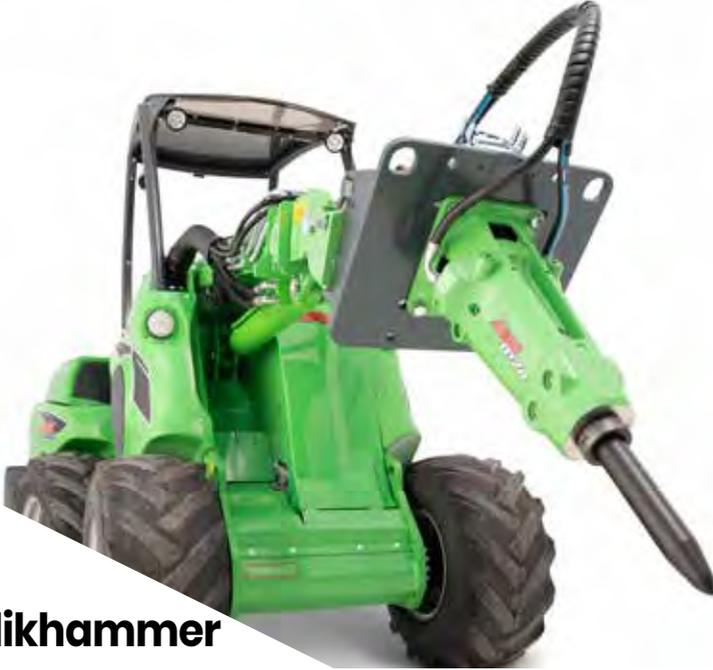
Der Avant Hydraulikhammer wurde speziell für den Einsatz mit Avant-Ladern entwickelt. Der B120-Hammer ist ein sehr kompaktes, aber leistungsstarkes Abbruchgerät mit robustem Design, großem Werkzeugdurchmesser und einem breiten zulässigen Öffnungsbereich, der für die meisten Avant-Ladermodelle geeignet ist.
