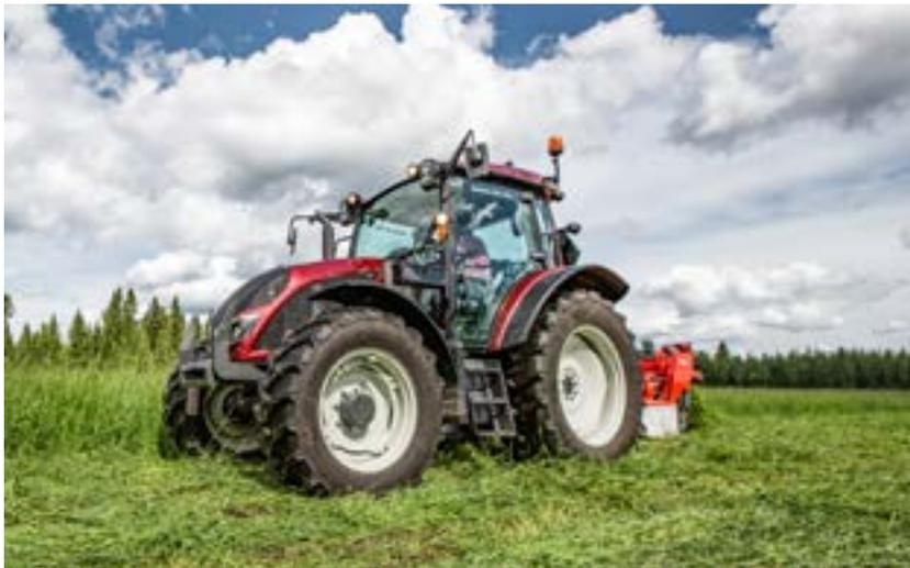
Die neuesten Modelle der A-Serie werden von AGCO POWER MBTN-D5-Motoren angetrieben. Die drei kleinsten Modelle haben 3,3 l Dreizylindermotoren, während die vier größten Modelle 4,4 l Vierzylindermotoren haben. Alle Motoren sind vollgepackt mit
