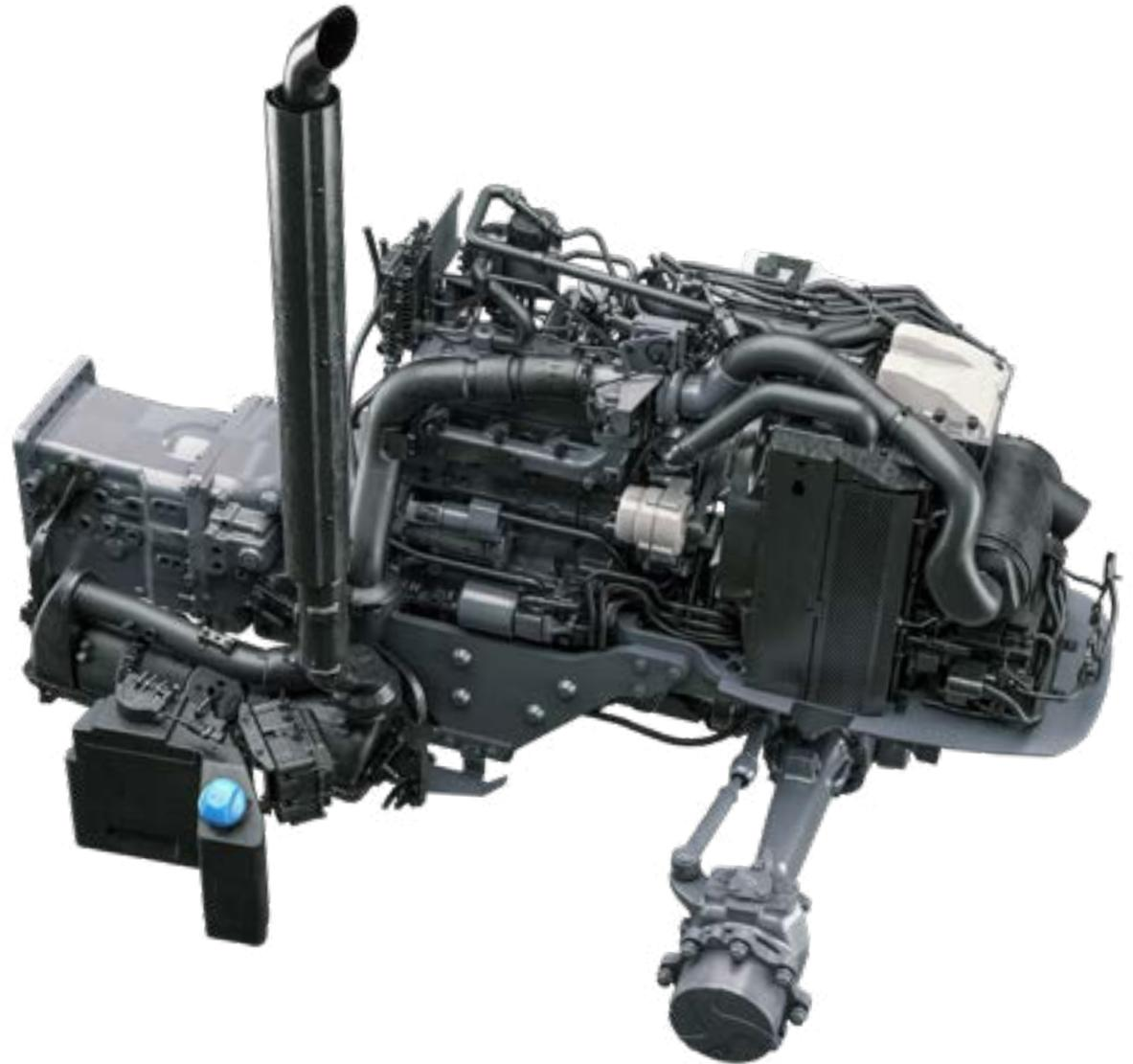
Abgasnachbehandlung der Stufe 5 unter der Kabine – für eine optimale Sicht nach vorn. Das Komplettpaket umfasst DOC, DPF und SCR unter Verwendung von AdBlue. Da es keine Abgasrückführung (EGR) gibt, verwendet der Motor immer frische, saubere Luft.
