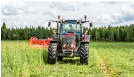
Einige Details werden Sie vielleicht gar nicht bemerken. Bei der Geräuschentwicklung kommt es zum Beispiel auf das an, was nicht da ist. So hat die Kabine der A-Serie einen Geräuschpegel von nur ca. 75 dB. Die Kabine ist vorn schmal, um Ihnen das Fahren in engen Bereichen wie Viehställen oder dichten Wäldern zu erleichtern. Und dennoch ist sie an der Schulterlinie breit für maximalen Arbeitskomfort.
